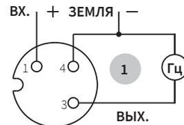
Разъем M12x1 без контактов для модуля измерения температуры
